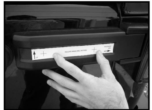
NOTICE: IN THE FOLLOWING STEPS THE TAILGATE HINGE BOLTS WILL BE REMOVED. THE WEIGHT OF THE TAILGATE RESTS ON THESE BOLTS. BE SURE THAT ONLY ONE TAILGATE HINGE IS UNBOLTED AT A TIME. THIS WILL ENSURE THE TAILGATE REMAINS ADEQUATELY SUPPORTED.
